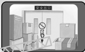
不占用、堵塞或封闭安全出口
