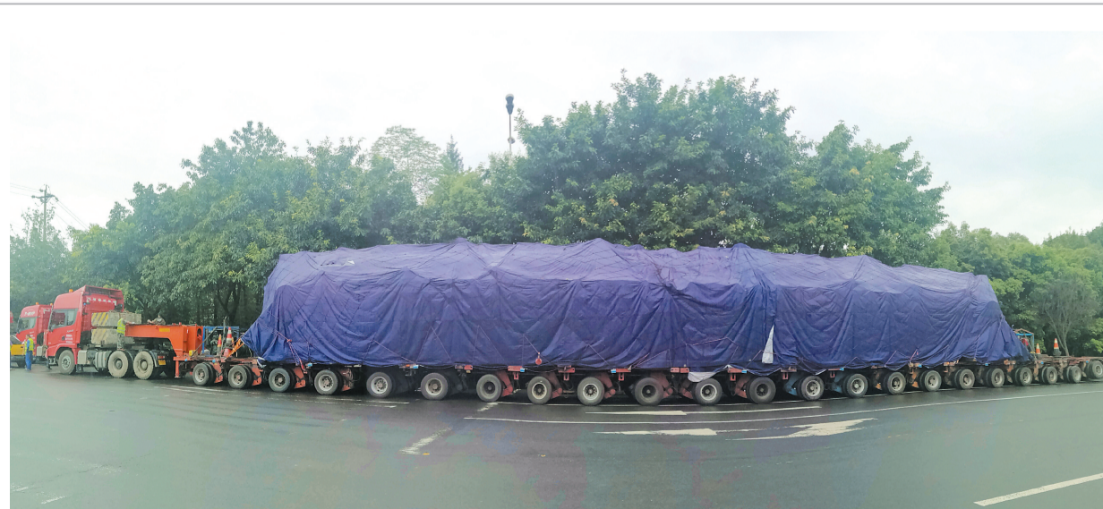
昨(26)日,一辆“巨无霸”大件运输车经过长途跋涉后抵达乐山。记者从市港航中心获悉,车上运输的大件设备重260吨,将在乐山大件码头“登船”,运往南美洲国家乌拉圭。据了解,此次抵乐的“巨无霸”是大型不可解体的锅炉设备,采用22轴线全挂液平板车装载运输,车辆装载后,车货长达49.2米,车货重359吨。 记者 宋雪摄
