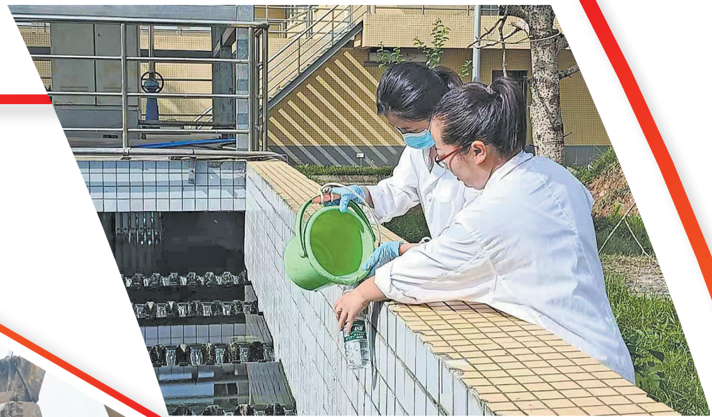
污水处理厂工作人员对污水进行采样
