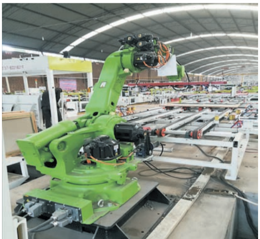
陶瓷大板生产线智能机械臂
