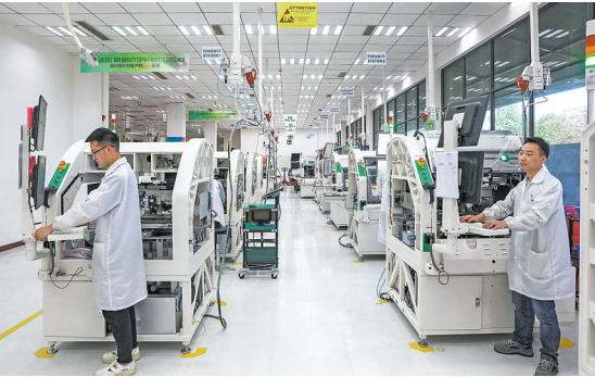
乐山博思半导体有限责任公司,工人正在操作贴片机。
