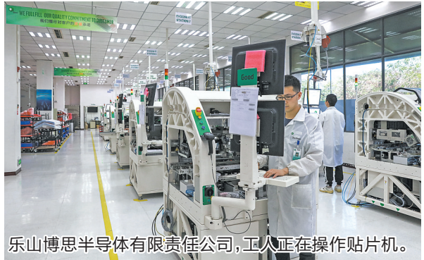
乐山博思半导体有限责任公司,工人正在操作贴片机。
