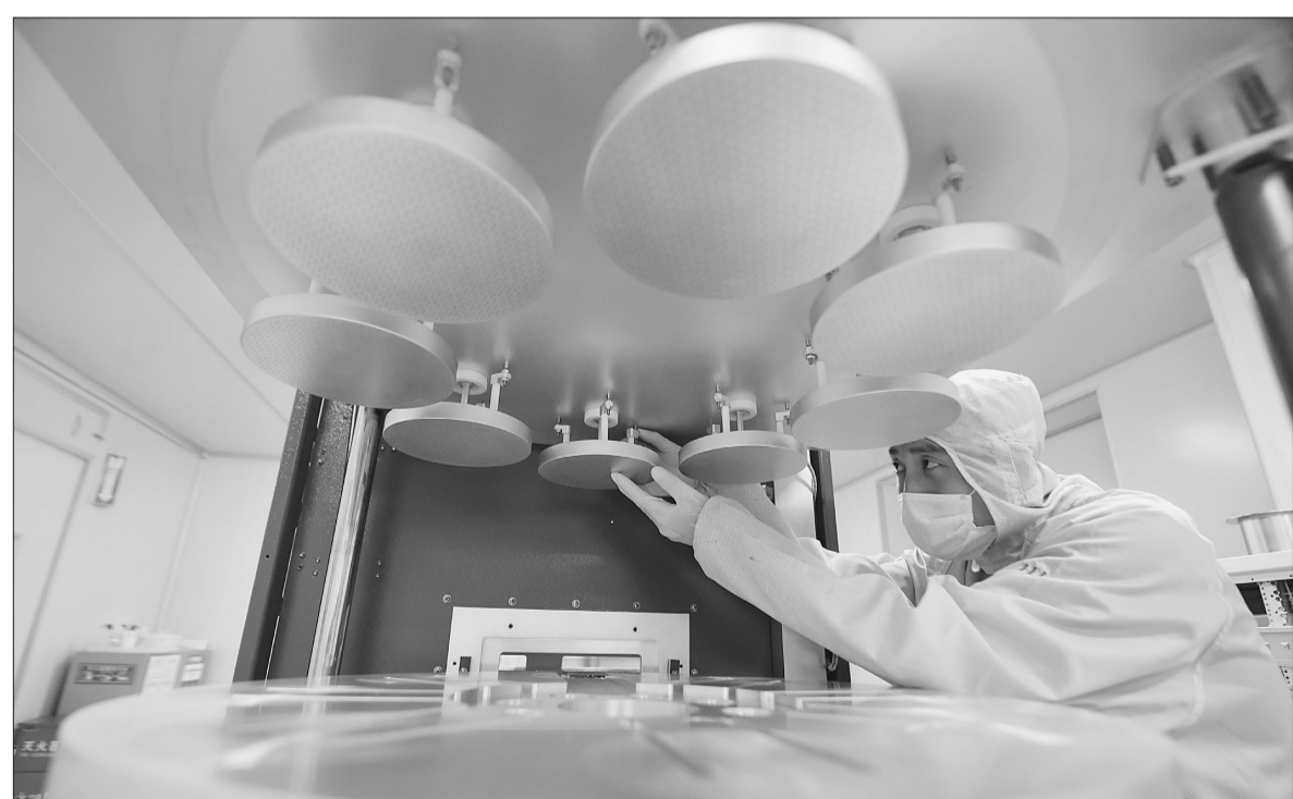
一家名不见经传的小公司,藏身于沈阳市浑南区一处僻静小院,投资仅3亿多元,历时短短四五载,就一举突破少数国际巨头的垄断,在全国首次实现大规模集成电路专用薄膜设备(PECVD设备)的量产,被誉为IC装备业界的“隐形冠军”。它就是沈阳拓荆科技有限公司。图为工作人员在组装6英寸大规模集成电路专用薄膜设备(PECVD设备)。
